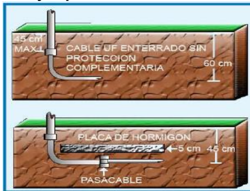
Ilustración 15. Ejemplo de Cable Directamente Enterrado
