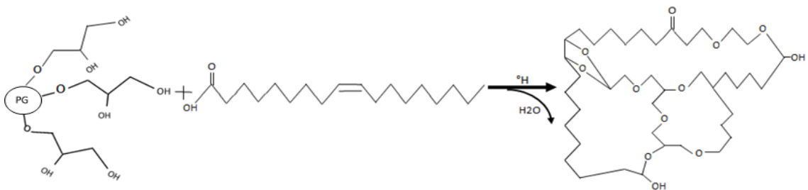
Figura 4. Reacción de entrecruzamiento de poliglicerol con ácido oleico
