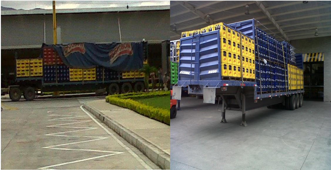
Figura 8. Proceso de cargue/descargue Botellero Tradicional
