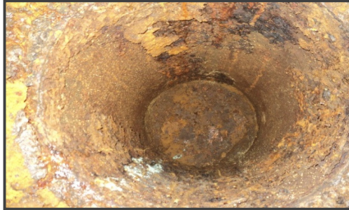
Figura. 20 Bota (A8) presencia de picado en los bordes
