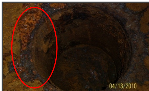
Figura. 20 Bota (A8) presencia de picado en los bordes
