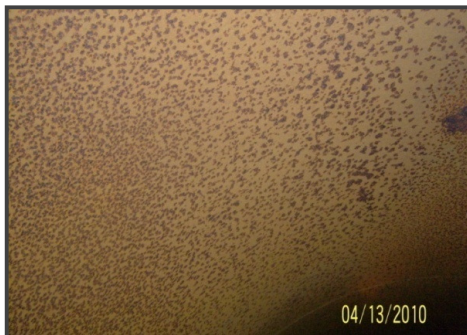
Figura. 27 Presencia de “Pinholes” en todo el cuerpo del recipiente.
