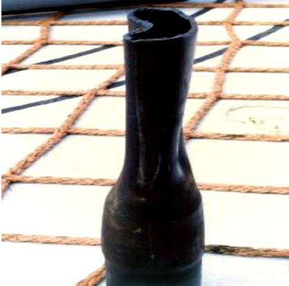
Figura 20. Efectos del colapso en las tuberías de revestimiento.
