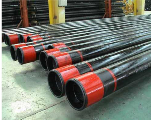
Figura 6. Tubería de revestimiento (casing).
