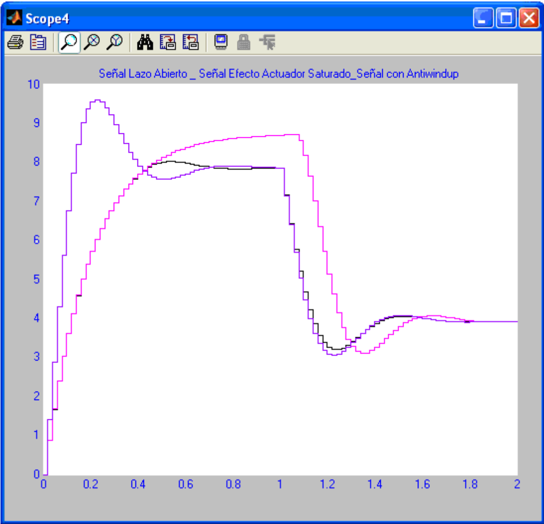
Figura 137. Gráficas, Lazo Cerrado actuador ideal (morado), Efecto Windup (magenta), Con Antiwindup (negro)
