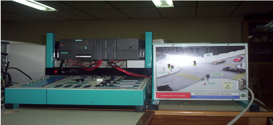
Figura 39. PLC Siemens S7-300 y mímico semáforo peatonal
