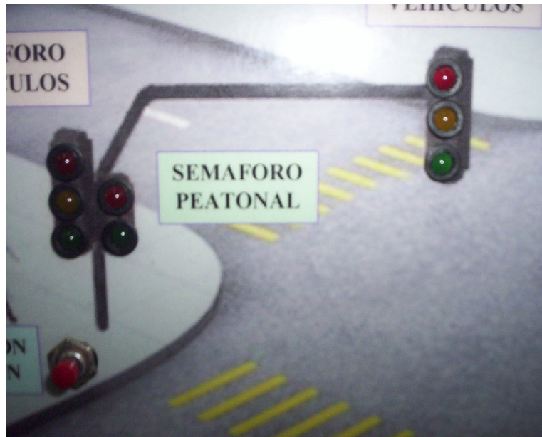
Figura 42. Pulsador en parada, semáforos intermitencia (encendidos)
