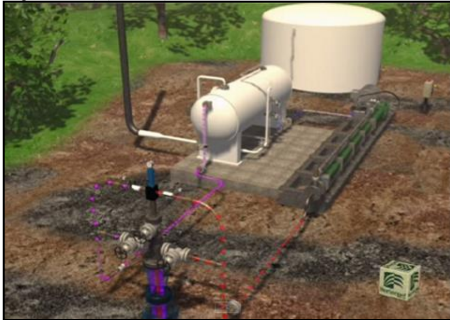
Figura 26 Equipo de superficie sistema Hidro-PCP. Sistema abierto
