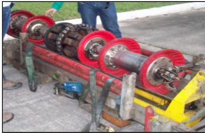
Figura 5. Operación de envío y recibo de raspador inteligente.
