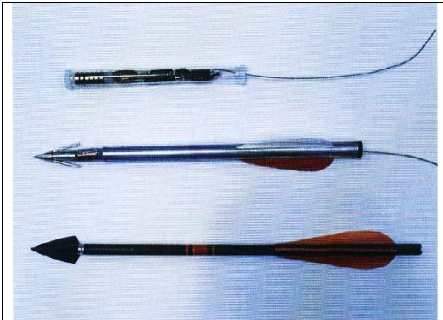
Imagen D.2. Dardo tipo dipolo. a) Transmisor RF y baterías, b) y c) Estructura dipolo con plumas estabilizadoras.
