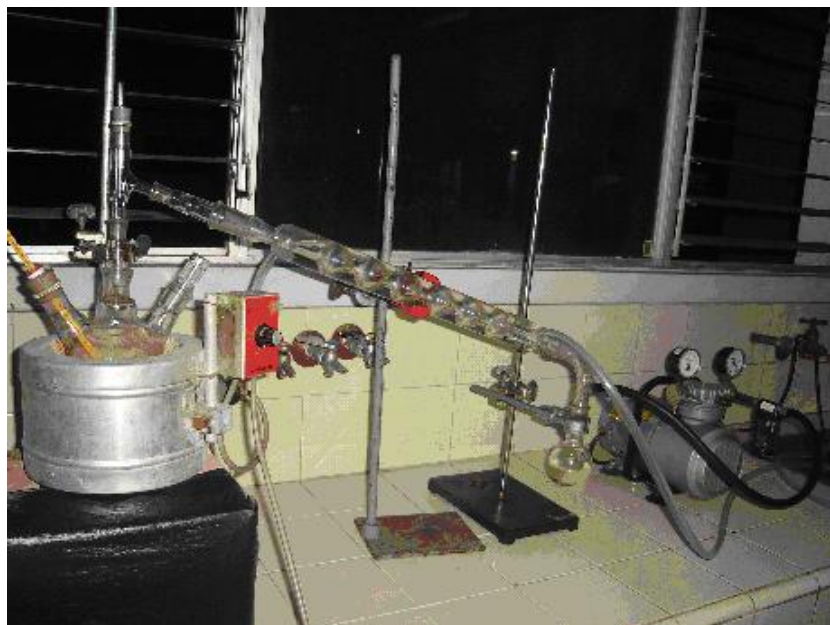
Figura 7. Montaje de destilación al vacío
