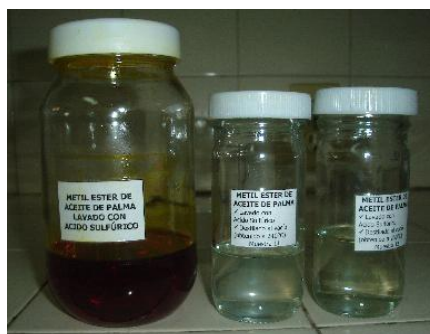
Figura 10. De izquierda a derecha. Muestra de metil ester antes de la destilación y las fracciones obtenidas mediante destilación al vacío
