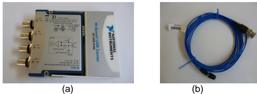
Figura 12. (a) Tarjeta de adquisición de datos NI-USB 9234 (b) cable coaxial.
