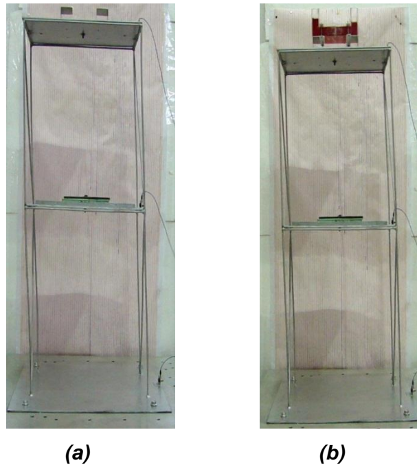
Figura 22. Fotografía de las amplitudes máximas alcanzadas por la estructura en la prueba experimental, para una frecuencia de 1.5 (Hz). (a) sin disipador de columna líquido (b) con disipador. Fuente: Los autores del proyecto
