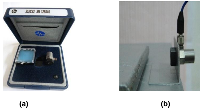
Figura 11. (a) Acelerómetro piezoeléctrico modelo 352C33 (b) Conexión acelerómetro-estructura.
