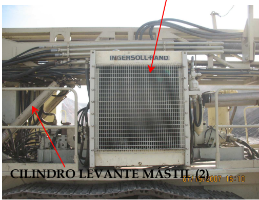
(a) RADIADOR Y ENFRIADOR HIDRAÚLICO
