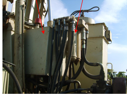
(d) TANQUE Y FILTROS HIDRAÚLICOS
