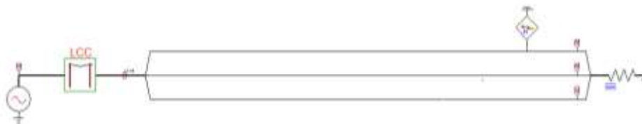
Figura 1. Línea A sencilla con impacto de rayo. Fuente. Elaboración propia.
