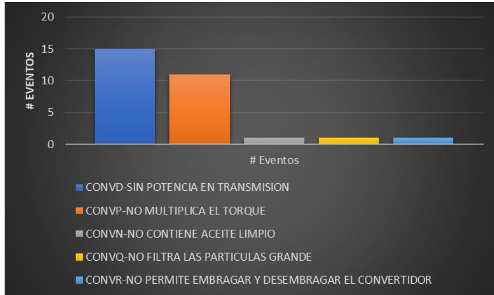
Figura 16: DIAGRAMA DE PARETO MODOS DE FALLA CONVERTIDOR DE TORQUE
