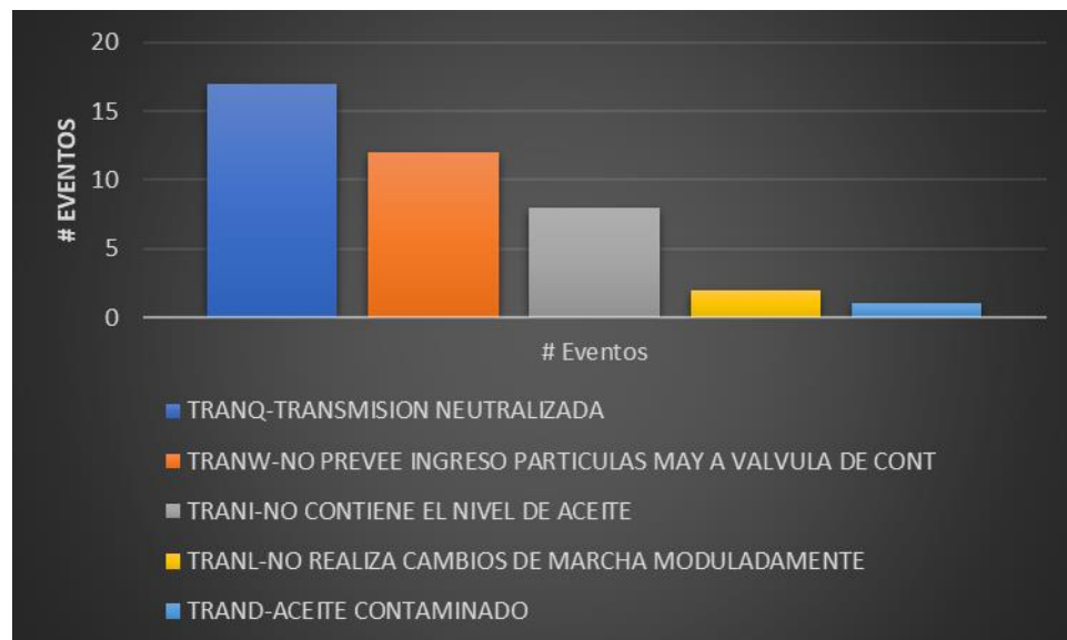
Figura 15: DIAGRAMA DE PARETO MODOS DE FALLA EN LA TRANSMISION
