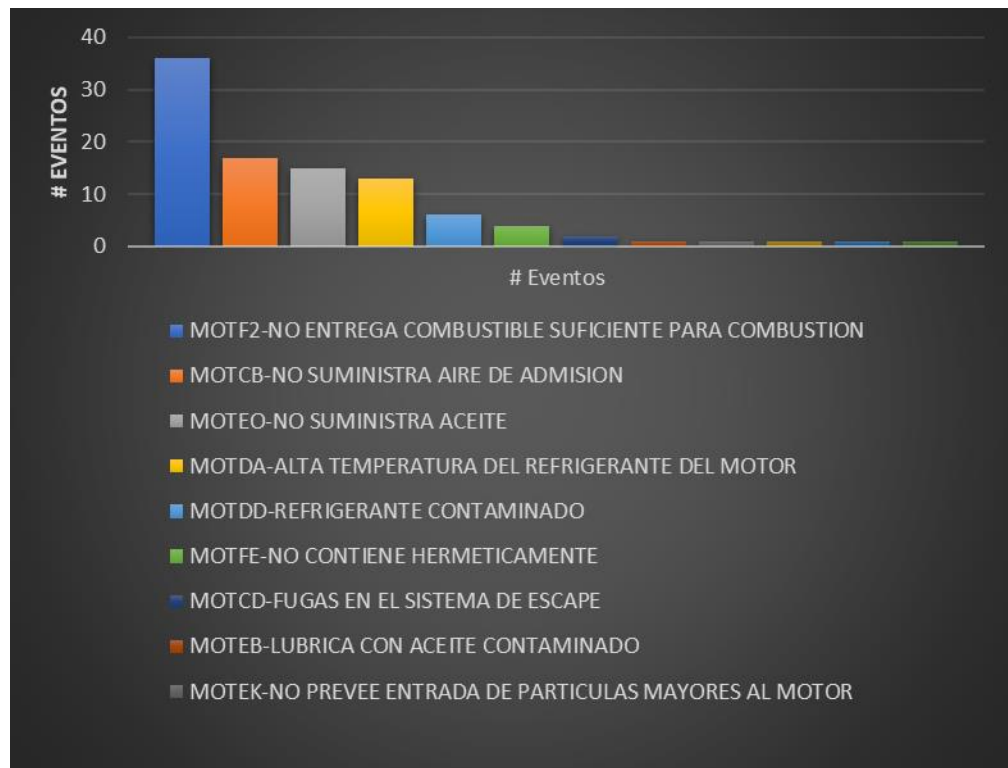
Figura 14: DIAGRAMA DE PARETO MODOS DE FALLA MOTOR
