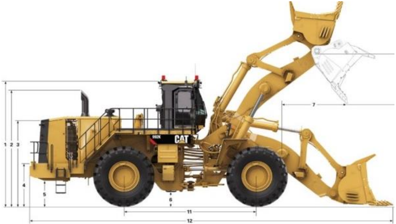
Figura 9: DIMENSIONES DEL CARGADOR 992C
