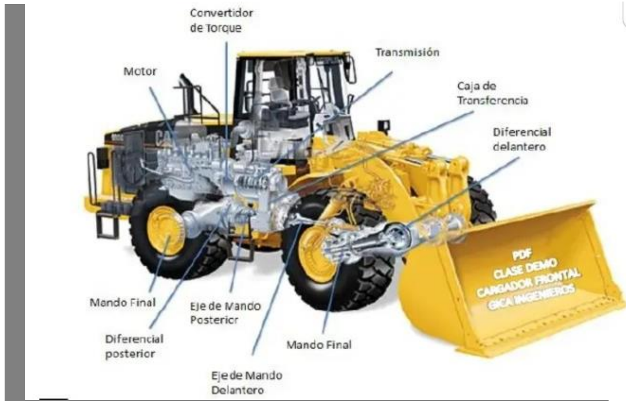
Figura 10: TREN DE POTENCIA. UBICACIÓN DE COMPONENTES.
