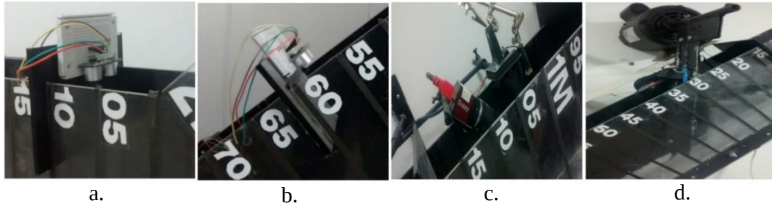
Figura 54. Instrumentación del canal para captura de datos. 1. Sensor ultrasonido en la sección horizontal. 2. Sensor ultrasonido en la sección inclinada. 3. Cámara CCD y estación laser. 4. Motor, sensor óptico y compuerta de retención.
