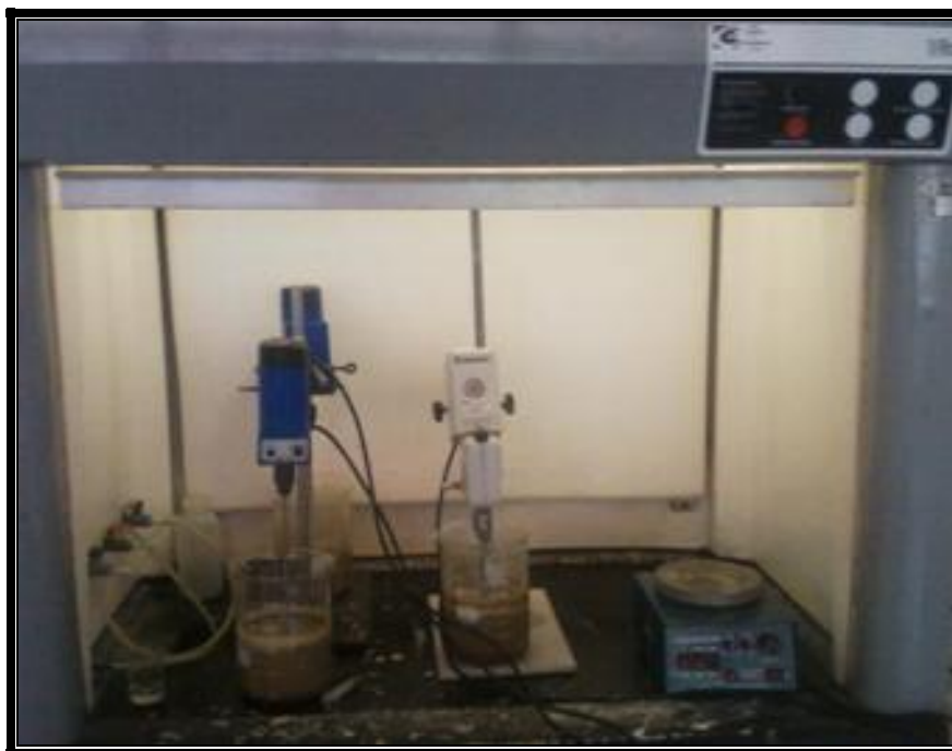
FIGURA 7. Montaje utilizado en los ensayos de cianuración.
