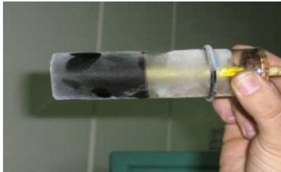
Figura 33. Determinación del punto de fluidez de una muestra de crudo.
