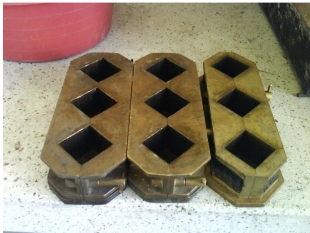
Foto 23 Moldes Para Ensayo de compresión
