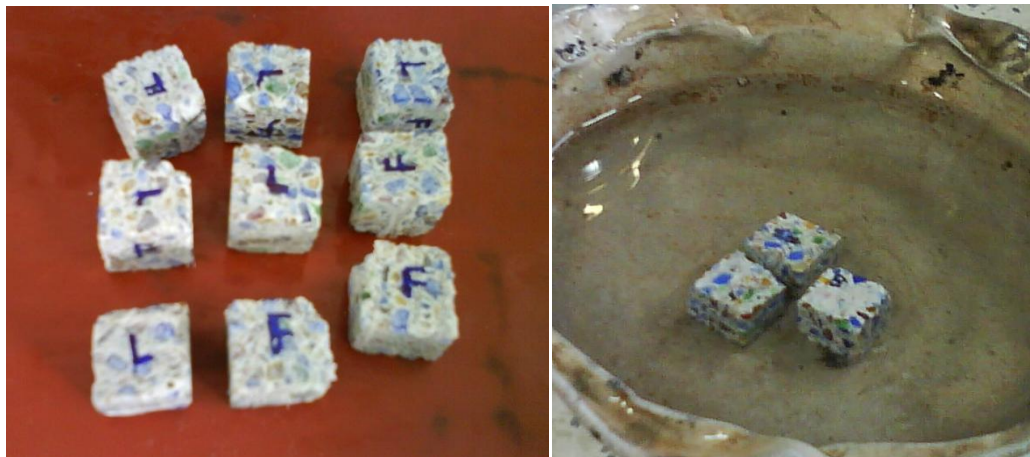
Foto 12 Probetas Cubicas Ensayo de Porosidad
