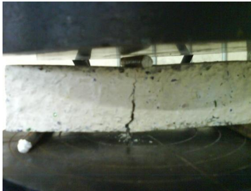
Foto 27 Falla por Flexión del Concreto
