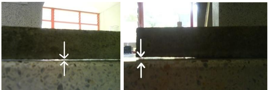
Foto 37 Deformaciones que Sufren los Modelos Después del Ensayo
