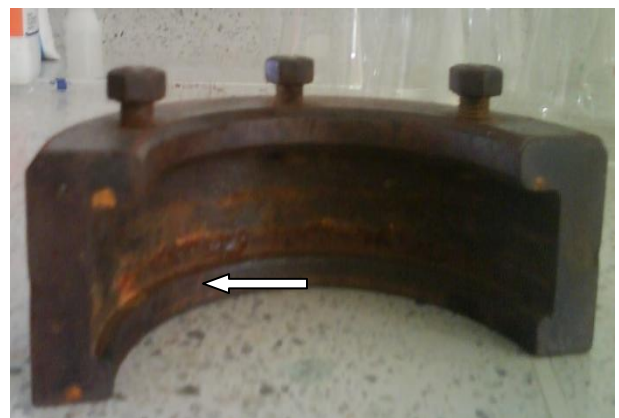
Foto 40 Corrosión que Presenta la Tapa Hermética.
