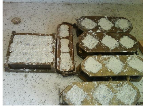
Foto 24 Elaboración Probetas Ensayo de compresión
