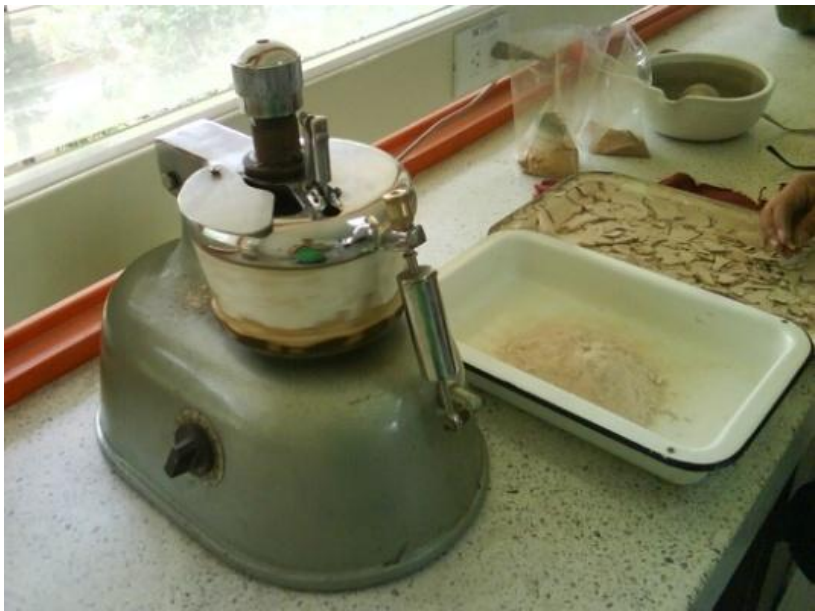
Foto 4 Molino Para Obtención del MK
