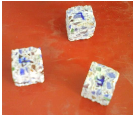
Foto 14 Probetas Cubicas Ensayo de Permeabilidad
