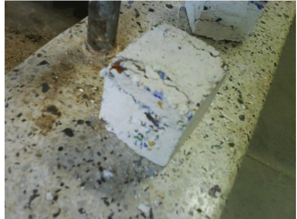
Foto 25 Probeta sometida a compresión y Probeta Fallada
