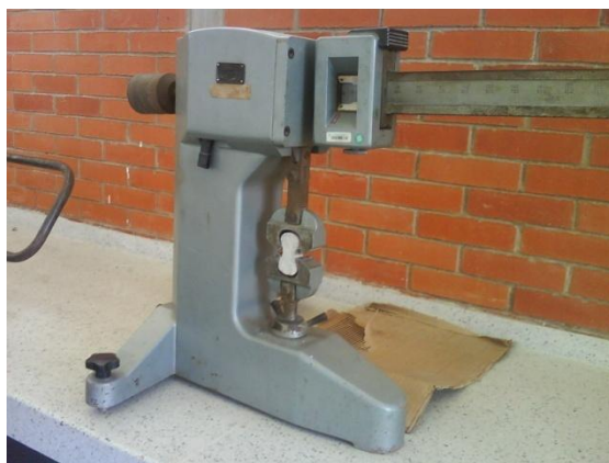
Foto 10 Montaje Ensayo de Tracción
