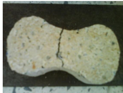
Foto 29 Falla de las probetas del Ensayo de Tracción
