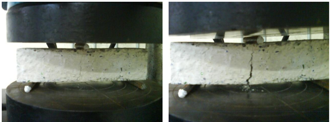
Foto 9 Montaje Ensayo de Flexion
