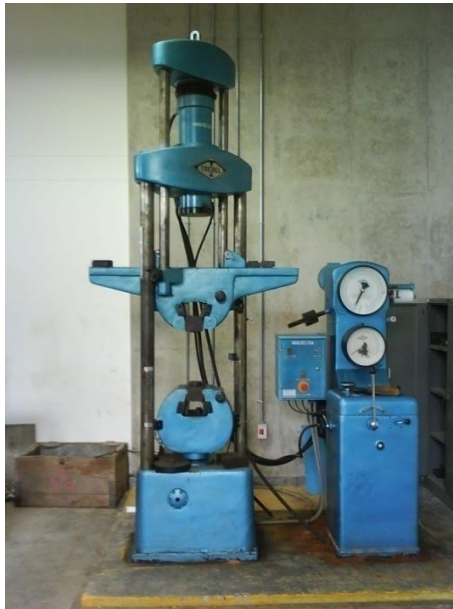
Foto 7 Máquina Universal de Ensayos TREBEL
