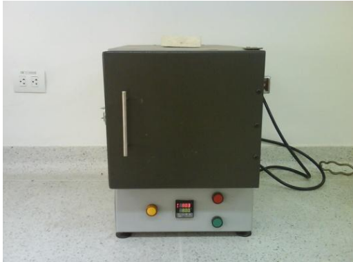
Foto 5 Horno De Calcinación Del Caolín y Temperatura Promedio de 800 grados
