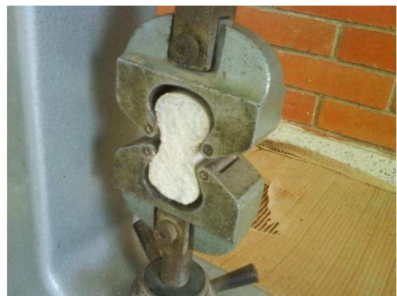
Foto 10 Montaje Ensayo de Tracción
