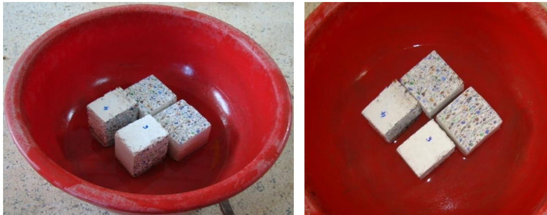
Foto 34 Ensayo de Absorción Capilar
