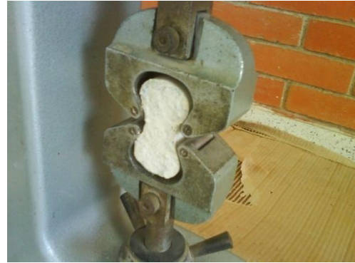
Foto 28 Montaje Ensayo de Tracción
