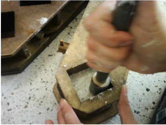
Foto 24 Elaboración Probetas Ensayo de compresión
