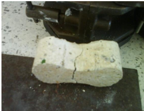
Foto 29 Falla de las probetas del Ensayo de Tracción
