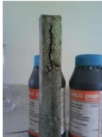
Foto 38 Fisura que Muestra la Probeta después del Ensayo
