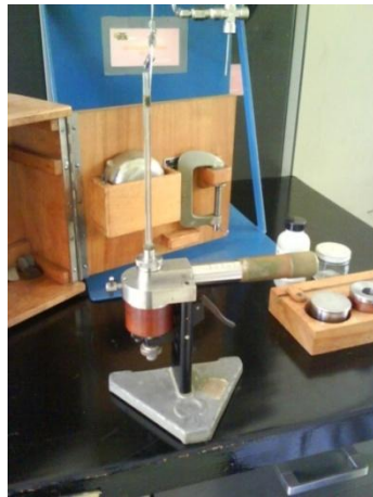
Foto 30 Porosímetro de campo Ruska y Muestras de porosidad.
