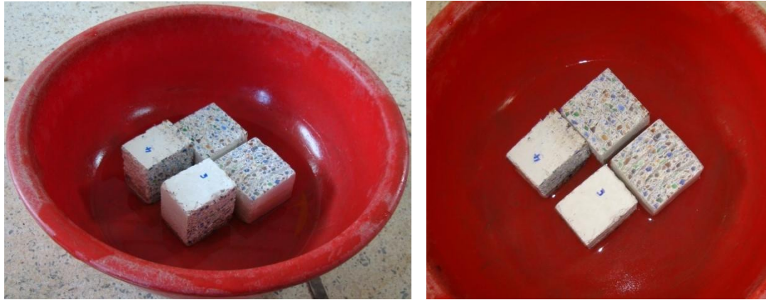
Foto 15 Probetas ensayo absorción capilar
