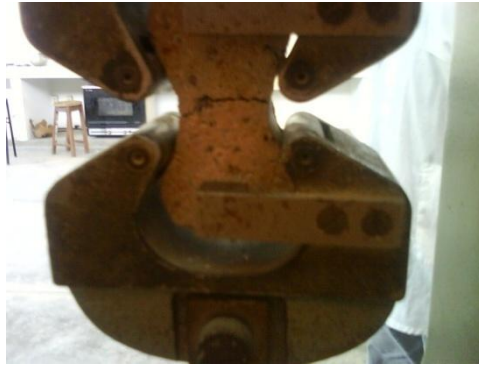
Foto 28 Montaje Ensayo de Tracción
