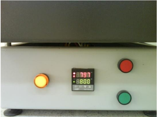
Foto 5 Horno De Calcinación Del Caolín y Temperatura Promedio de 800 grados
