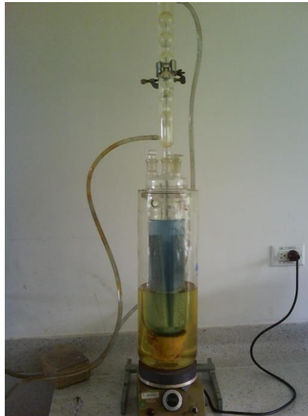
Foto 17 Montaje de Recirculación de agua y Condensación de los Vapores Liberados en el Proceso
