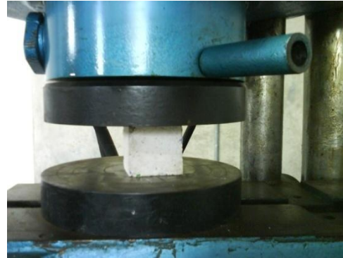
Foto 8 Montaje del Ensayo de Compresión
