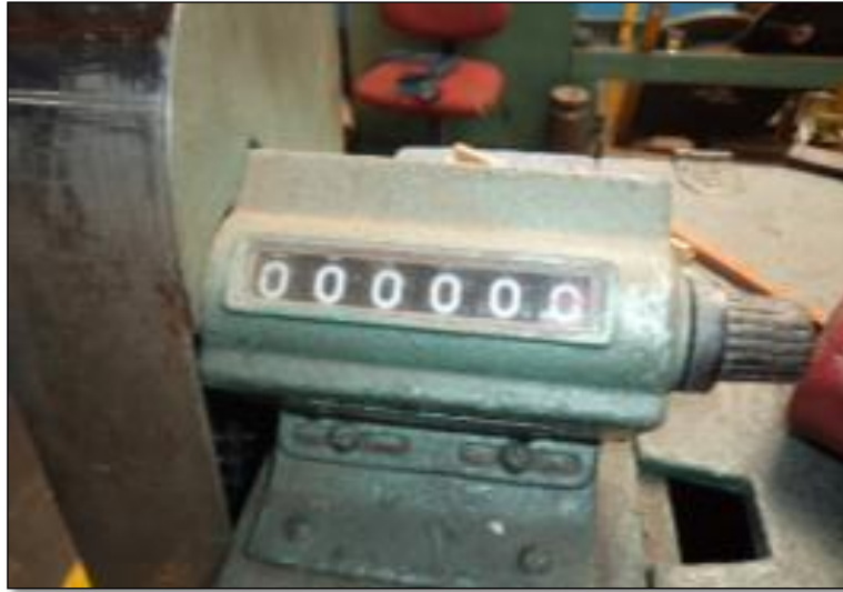
Figura 79 Contador de vueltas en maquina bobinadora.
