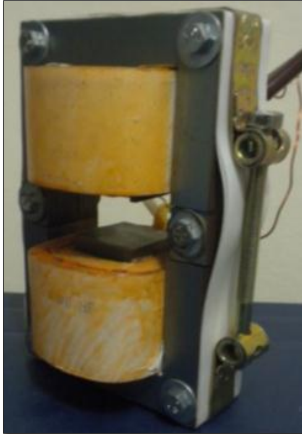
Figura 92 Sistema completo de sujeción de la herramienta magnética
