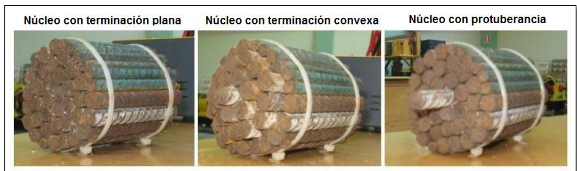
Figura 6 Prototipos para escoger la forma óptima del núcleo.
