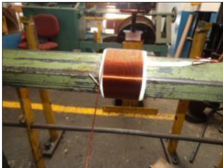
Figura 77 Finalización de primera sección del bobinado.
