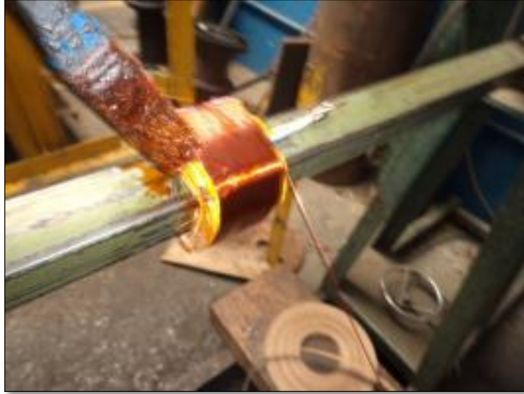
Figura 81 Aplicación de barniz dieléctrico.
