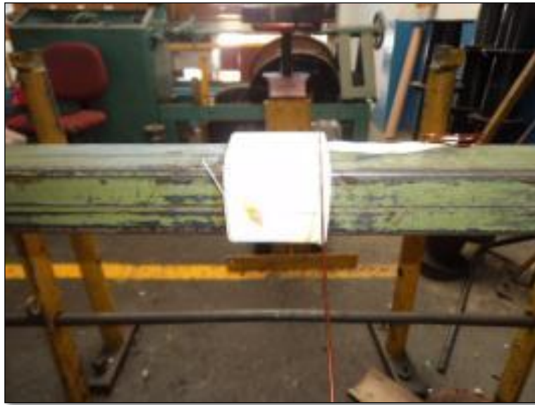
Figura 76 Inicio de primera sección del bobinado.
