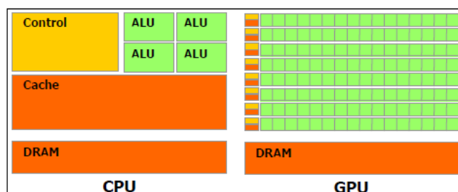
Figura 1. Imagen comparativa de la estructura de una CPU y una GPU. Tomado de NVIDIA CUDA compute Unified Device Architecture [7].
