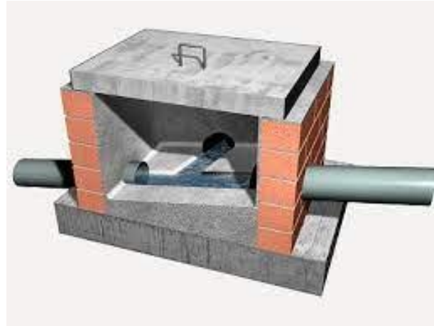
Ilustración 79. Construcción caja de inspección.
