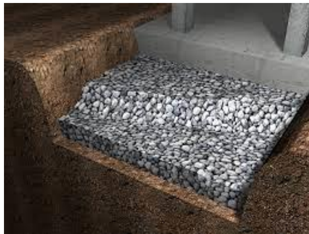
Ilustración 10. Relleno compactado con subbase.
