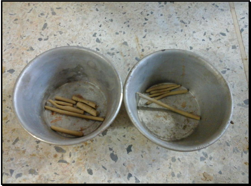
Figura 6. Rollos desquebrajados al alcanzar el límite plástico.
