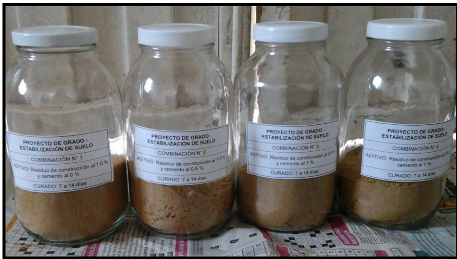
Figura 29. Muestras de suelo aditivadas
