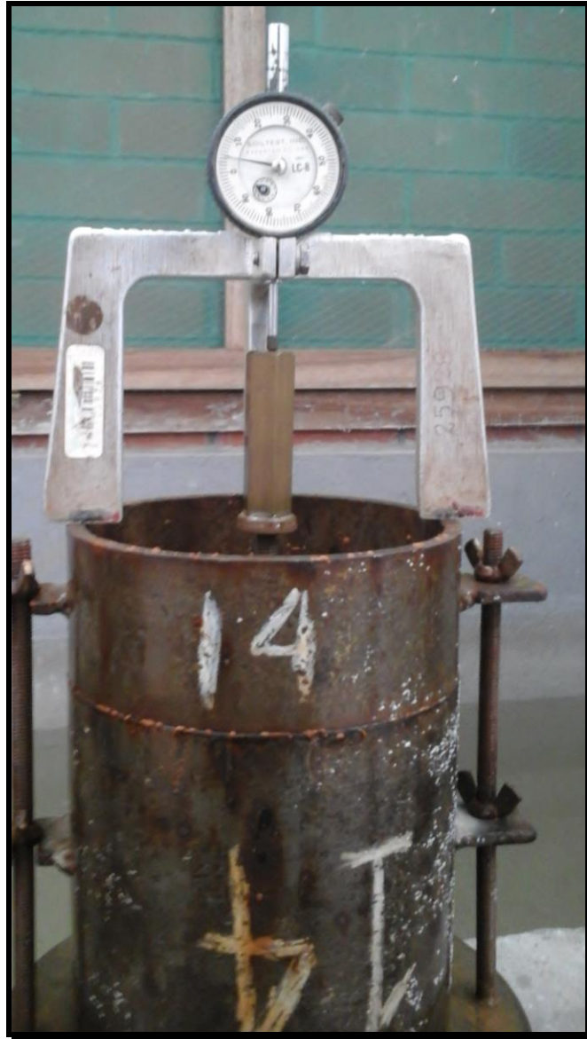
Figura 7. Deformación de la muestra después de estar sumergido en agua por cuatro días.
