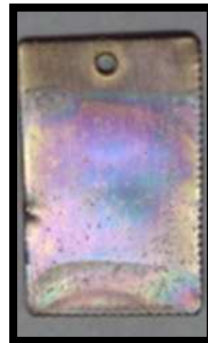
Sustrato de acero inoxidable 304 con película de TiO 2 .
