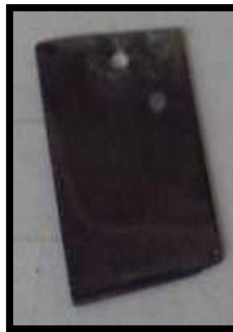
Cátodo de acero inoxidable 304 después del tratamiento fotoelectrolítico.
