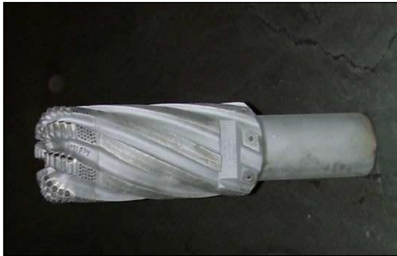
Figura 27. Broca de calibre extendido (Extended Gauge Bit).
