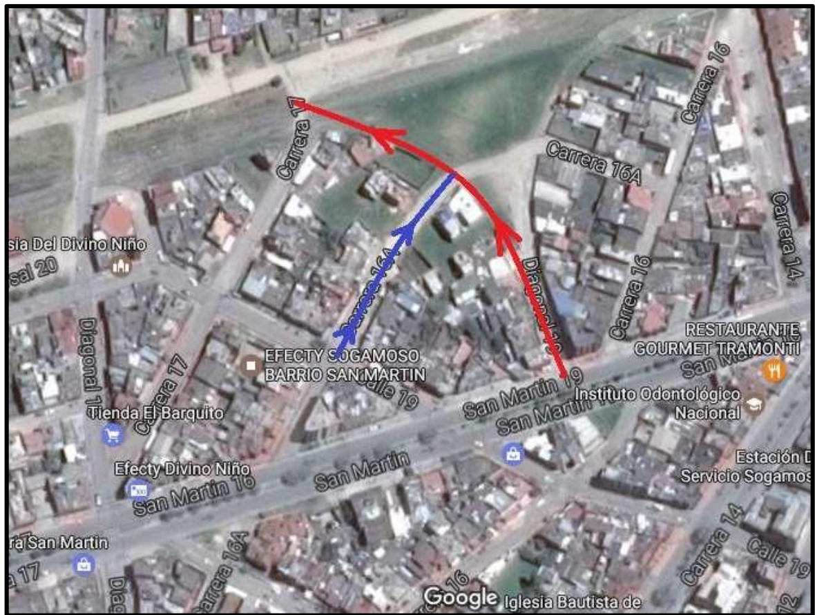
Figura: 48. Localización de las redes de alcantarillado.
