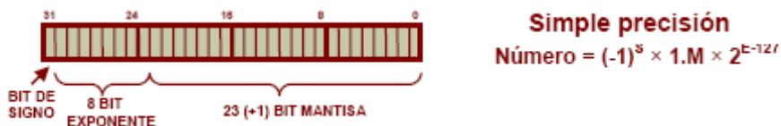
Figura A1. Formato IEEE 754. Simple precisión
