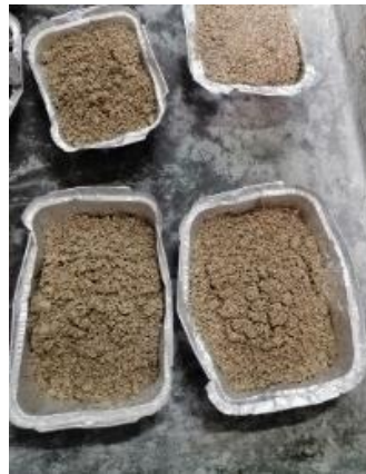
Ilustración 12. Muestras de agregado fino después de ponerlas en el horno.
