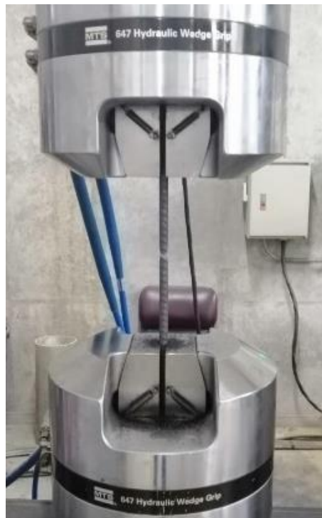
Ilustración 17. Barra de 3/8" al finalizar el ensayo de tensión.
