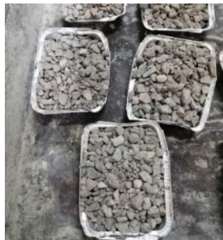
Ilustración 8. Muestras de agregado grueso después de ponerlas en el horno
