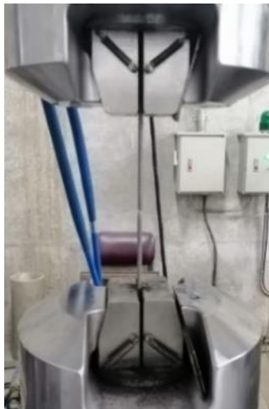
Ilustración 19. Barra de 1/4" al finalizar el ensayo de tensión.
