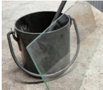
Ilustración 14. Molde para el ensayo y varilla de apisonamiento.
