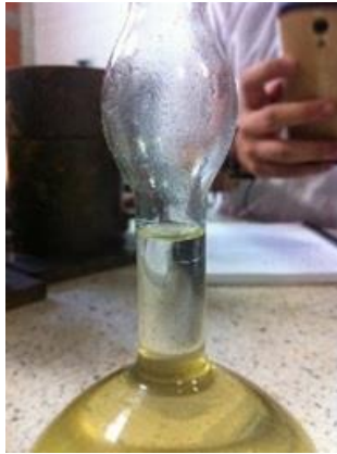
Ilustración 16. Queroseno en el frasco de Le Chatelier.
