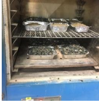
Ilustración 10. Muestras de agregado en el horno.
