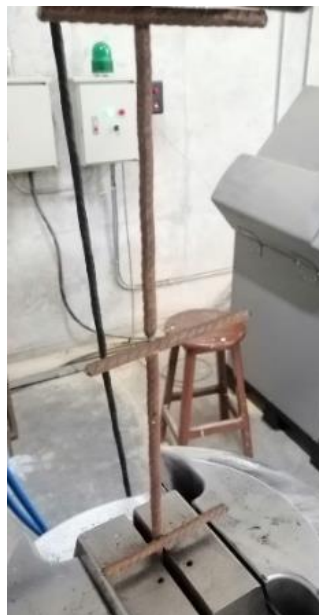
Ilustración 20. Malla electrosoldada de 6mm al finalizar el ensayo de tensión.
