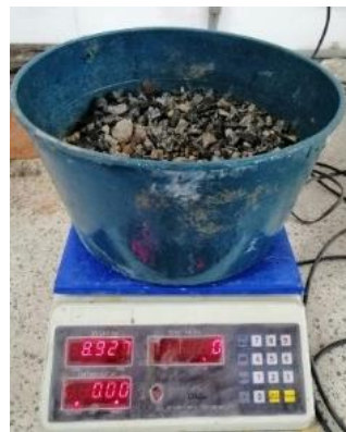
Ilustración 9. Muestras de agregado grueso antes de sumergirlo por 24 horas.
