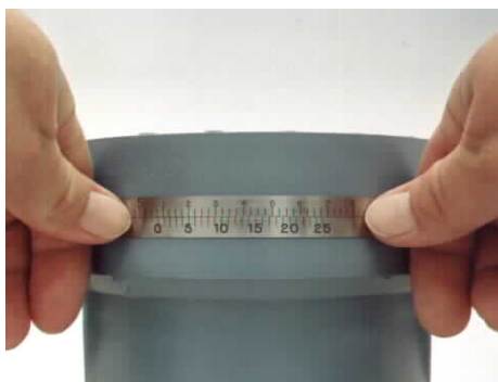
Figura 14. Instrumento de medición, Cinta pi
