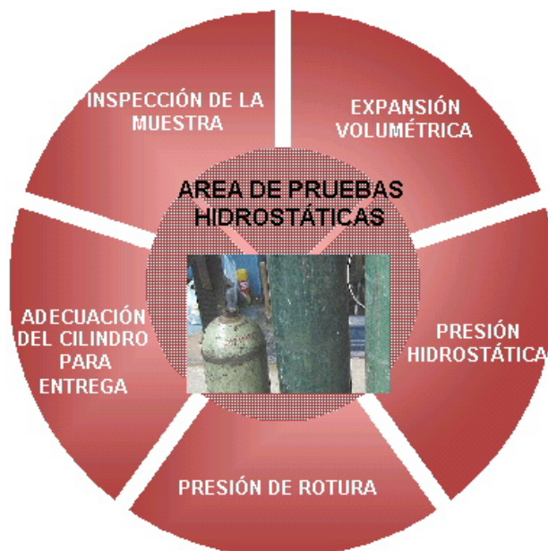
Figura 28. Ensayos elaborados en el área de pruebas hidrostáticas
