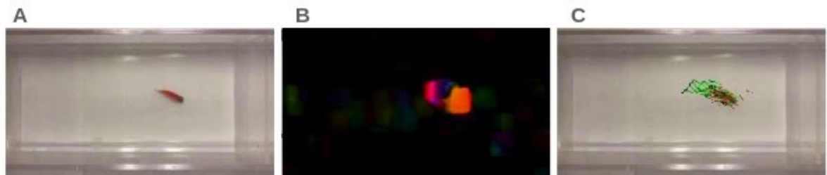
Figura 5. Ilustración del cálculo de trayectorias. A. Fotograma particular del pez en movimiento captado en vídeo desde una vista superior del tanque. B. La estimación del flujo óptico, se representa como un mapa de colores donde cada intensidad de color representa una dirección de los objetos en movimiento, la coloración circundante se debe a los movimientos aparentes del agua. C. Resultado final del cálculo de trayectorias extrayendo sólo las trayectorias de los peces.
