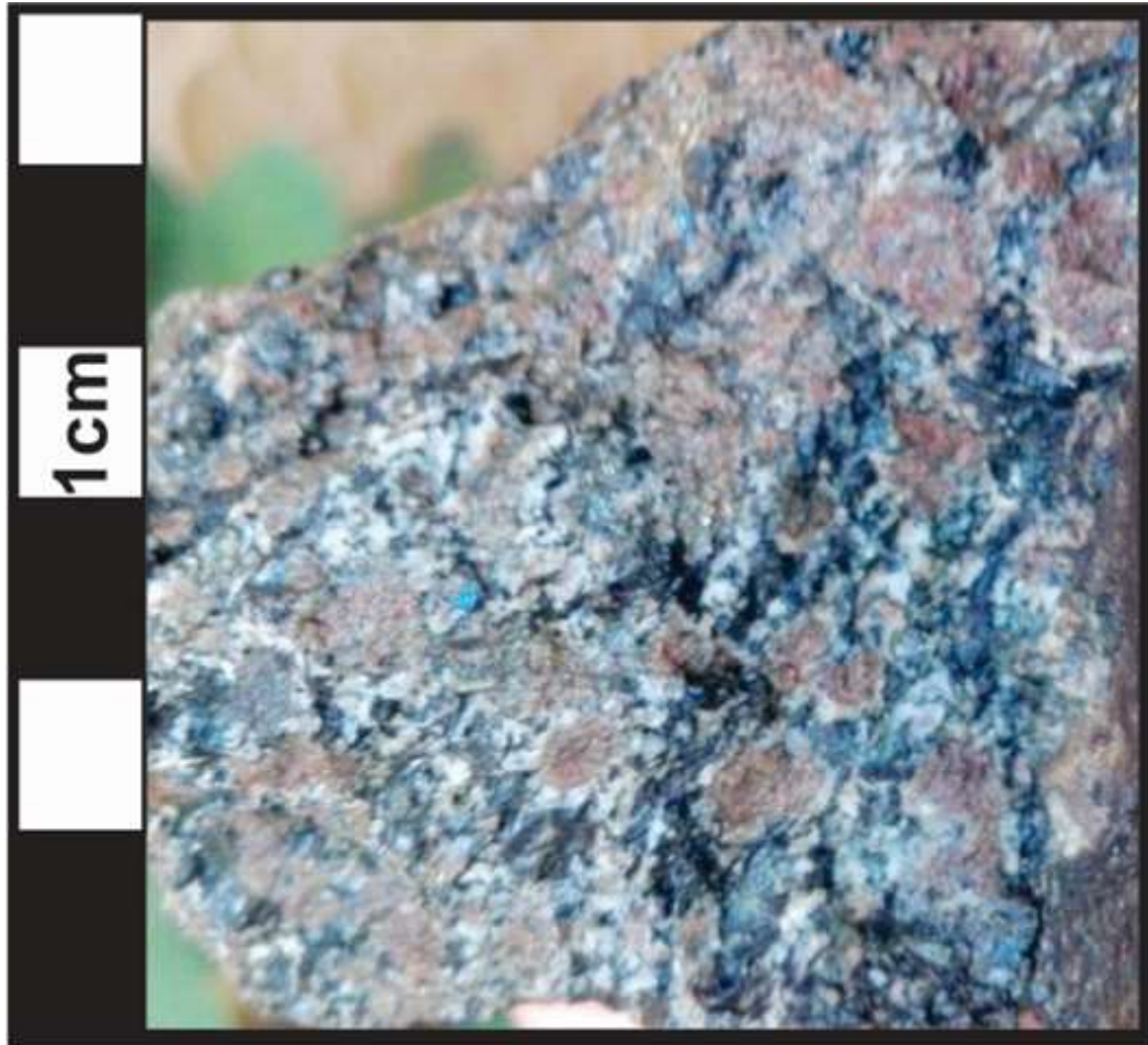
Figura 21. Muestra granulita máfica. (A) Muestra de mano de granulita máfica donde se identifica su estructura foliada, desarrollada por los anfíboles (color verde oscuro) y plagioclasa (color blanco). Los cristales de granate (color café) y piroxenos (color negro) se encuentran distribuidos en bandas por la muestra. Además se puede observar el desarrollo de texturas coroníticas de plagioclasa (color blanco) en granates (color rojo) muy gruesos. También es posible evidenciar estructura “White Socked” en Piroxenos.
