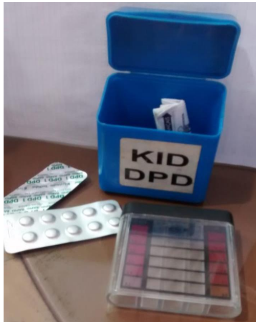
Figura 13. Instrumento de verificación de parámetros para control del agua.
