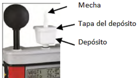
Ilustración 8. Llenado del depósito del bulbo húmedo
