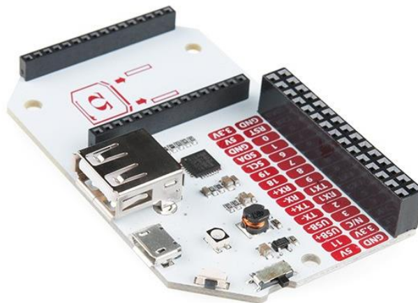
Figura 6. Fotografía del Expansion Dock de la Omega2+.
