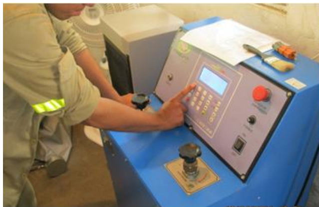
Figura 38. Visor digital de la máquina de ensayos de compresión
