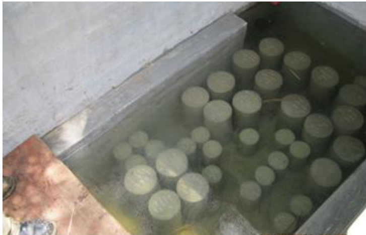
Figura 35. Tanque de agua con cilindros en su interior
