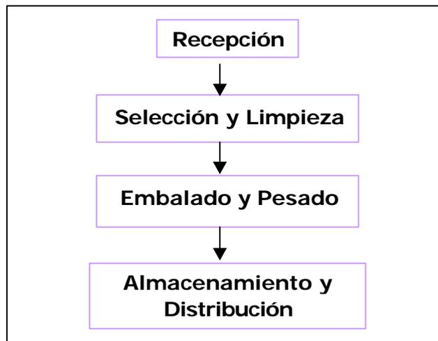
**Figura 3. Proceso básico para el acondicionamiento de papel y cartón reciclados.**
