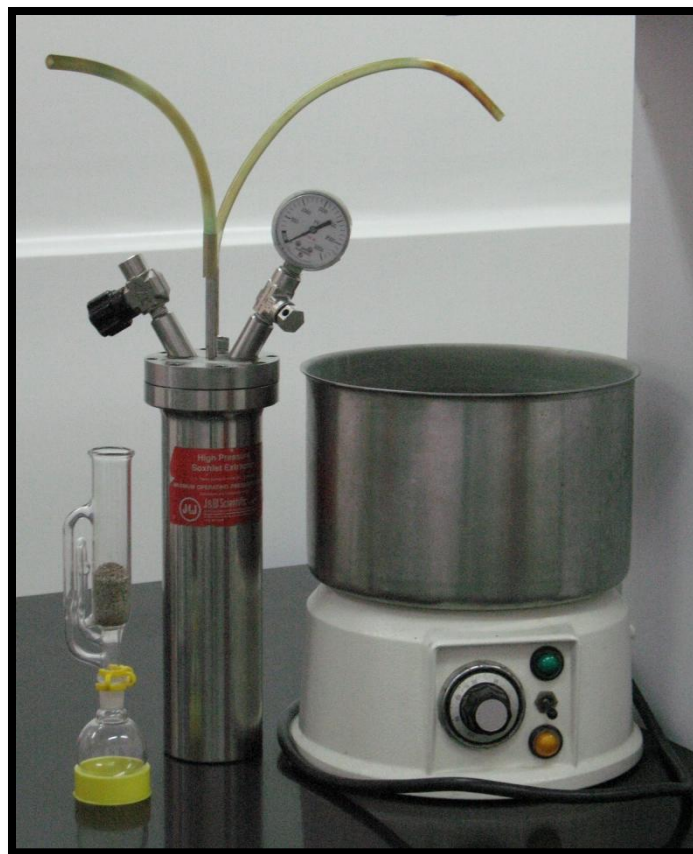
Figura 22. Equipo Soxhlet de alta presión (J & W Scientific) para la SFE con CO 2 . Fotografía tomada por Mario A. Llinás. Lugar: CENIVAM, UIS. Fecha: Octubre de 2011.
