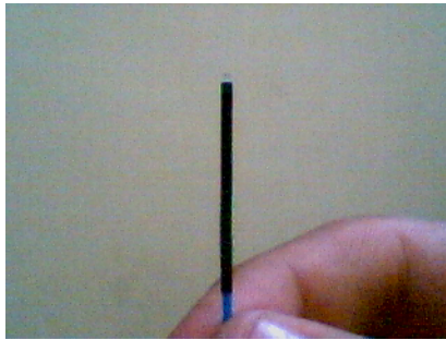
Figura 11. Fotografía del sensor de temperatura FOT -L
