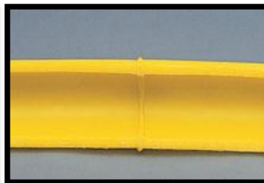
Con ranuras o vacíos entre tubos
