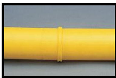
Demasiada presión y temperatura
