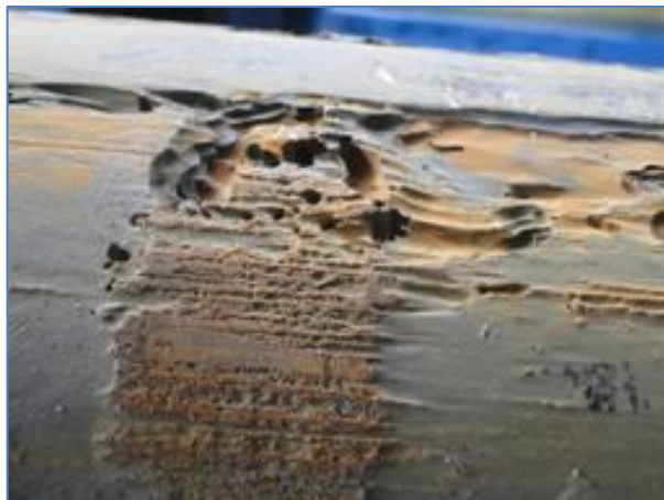
Figura 7. Estado Housing de la bomba electrosumergible del pozo en 2011.
