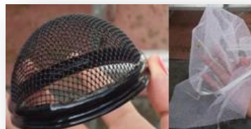
Figura 4. Mallas colocadas en el pluviógrafo de la EST1.
