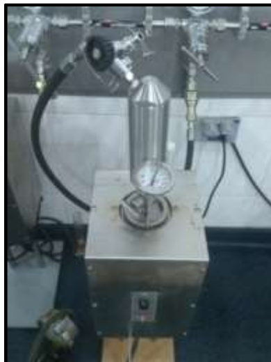
Figura 19. Termómetro en orificio de celda, Prueba PPT
