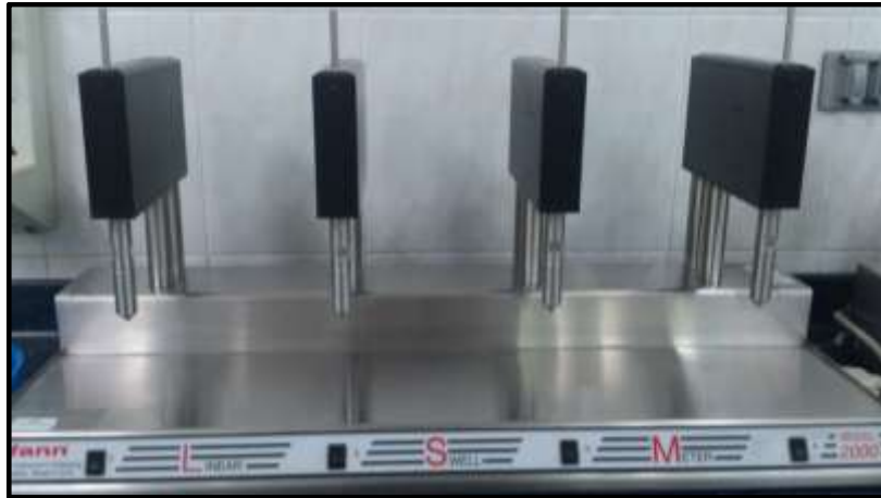
Figura 21. Equipo para prueba de Hinchamiento Lineal.
