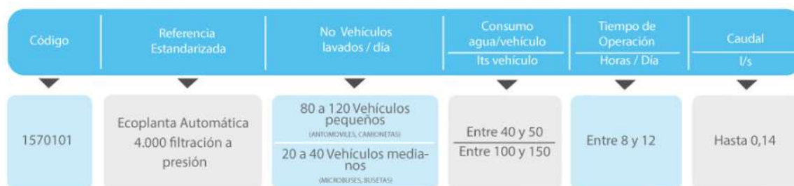
Ilustración 5 Plantilla de capacidad de eco planta
