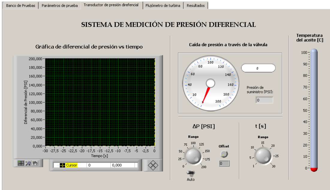
Figura 84. Sistema de medición de presión diferencial del panel de control.
