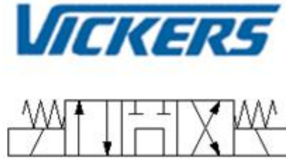
Figura 101. Montaje de la válvula VICKERS 4/3 centro tándem.
