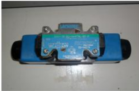
Figura 101. Montaje de la válvula VICKERS 4/3 centro tándem.
