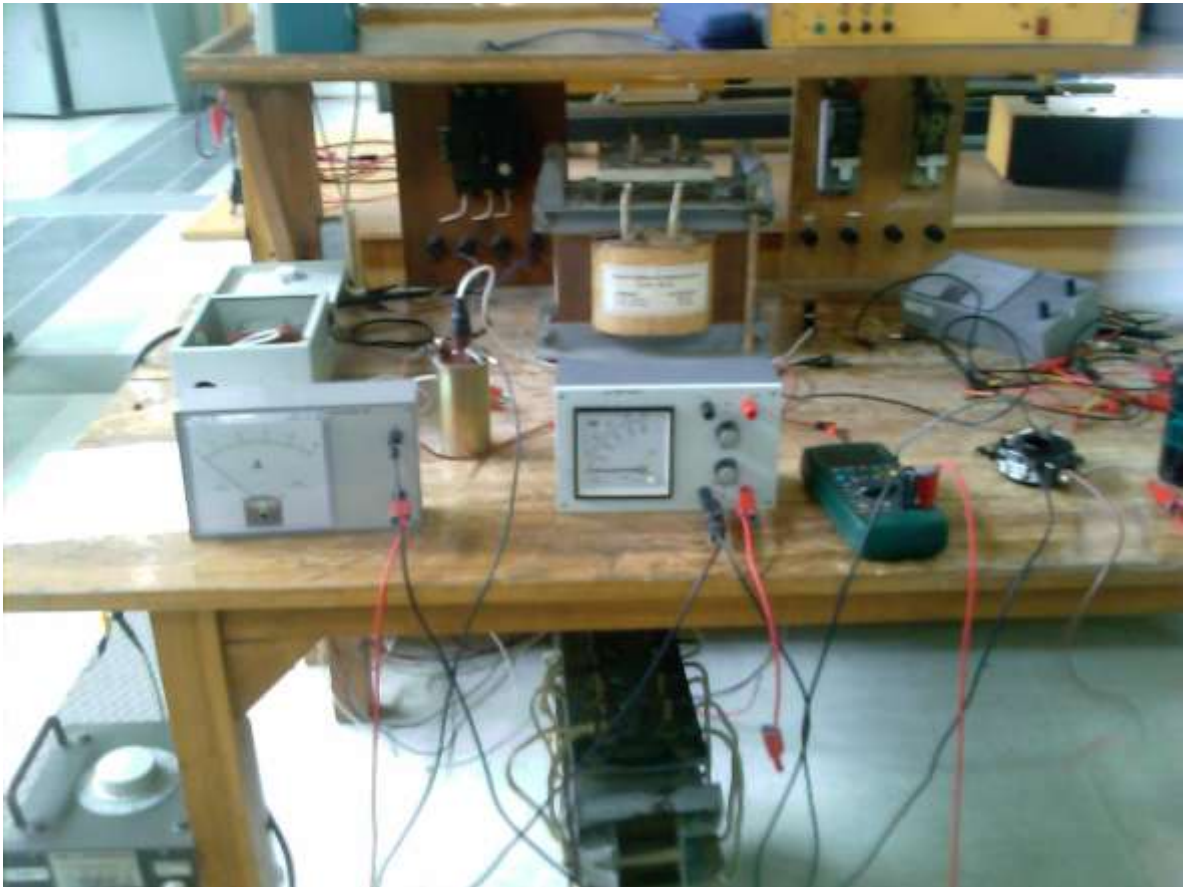
Figura 60. Esquema de conexión general para el ensayo de vacío de la bobina de ignición empleada.
