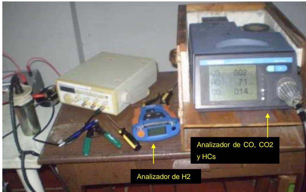
Figura 64. Detalle de los equipos de análisis de gases.
