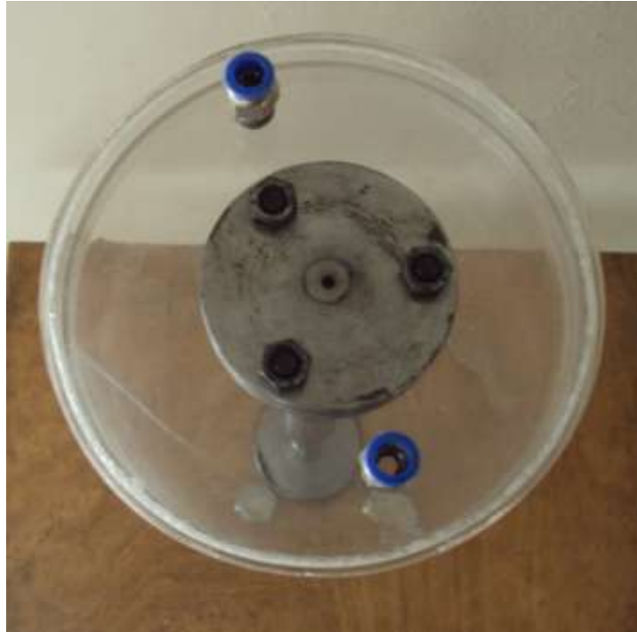
Figura 47. Vista superior del reactor de gasificación.
