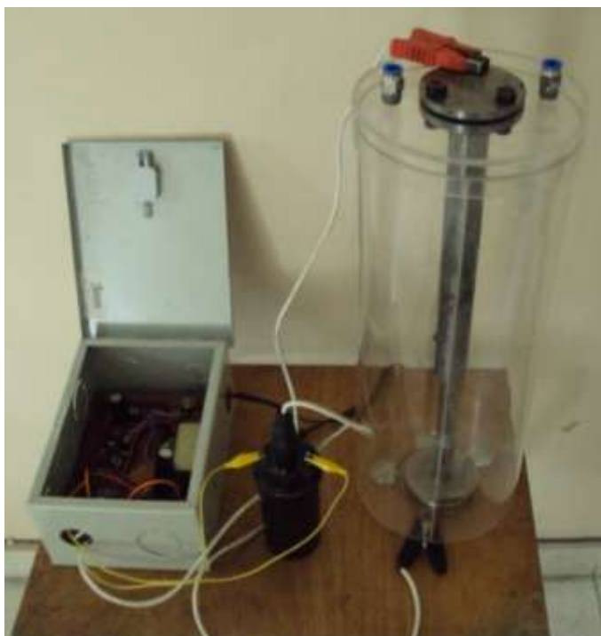
Figura 40. Vista general de la conexión entre el circuito generador de arco eléctrico diseñado inicialmente y el reactor preliminar de gasificación de glicerina por plasma.
