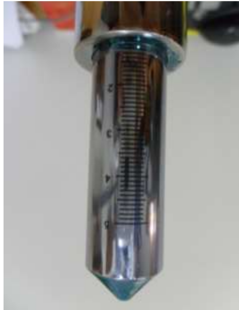
Figura 49. Detalle del electrodo superior cromado y graduado.
