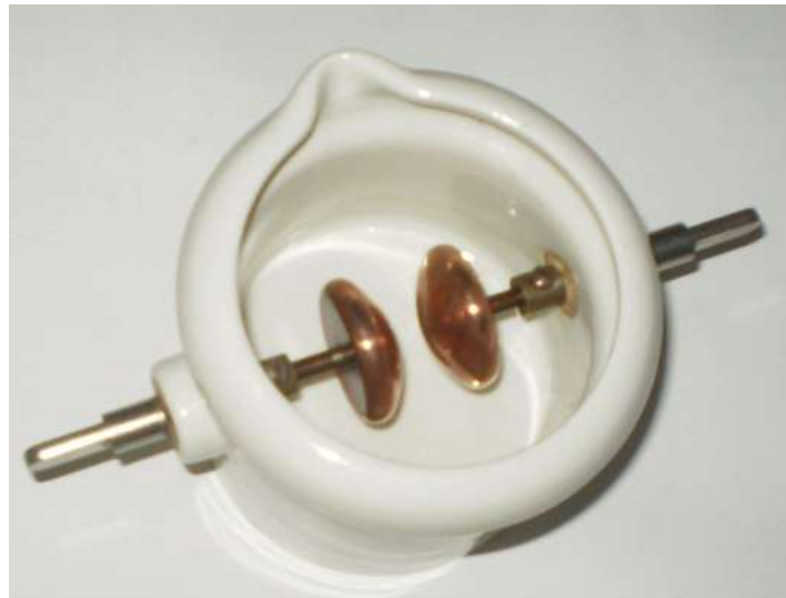
Figura 57. Recipiente empleado en el chispómetro con electrodos en forma de hongo.
