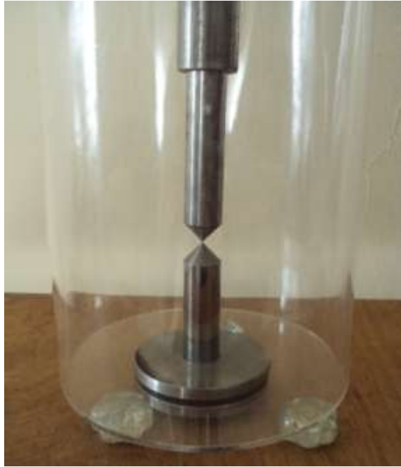
Figura 48. Primer plano de los electrodos en el reactor.
