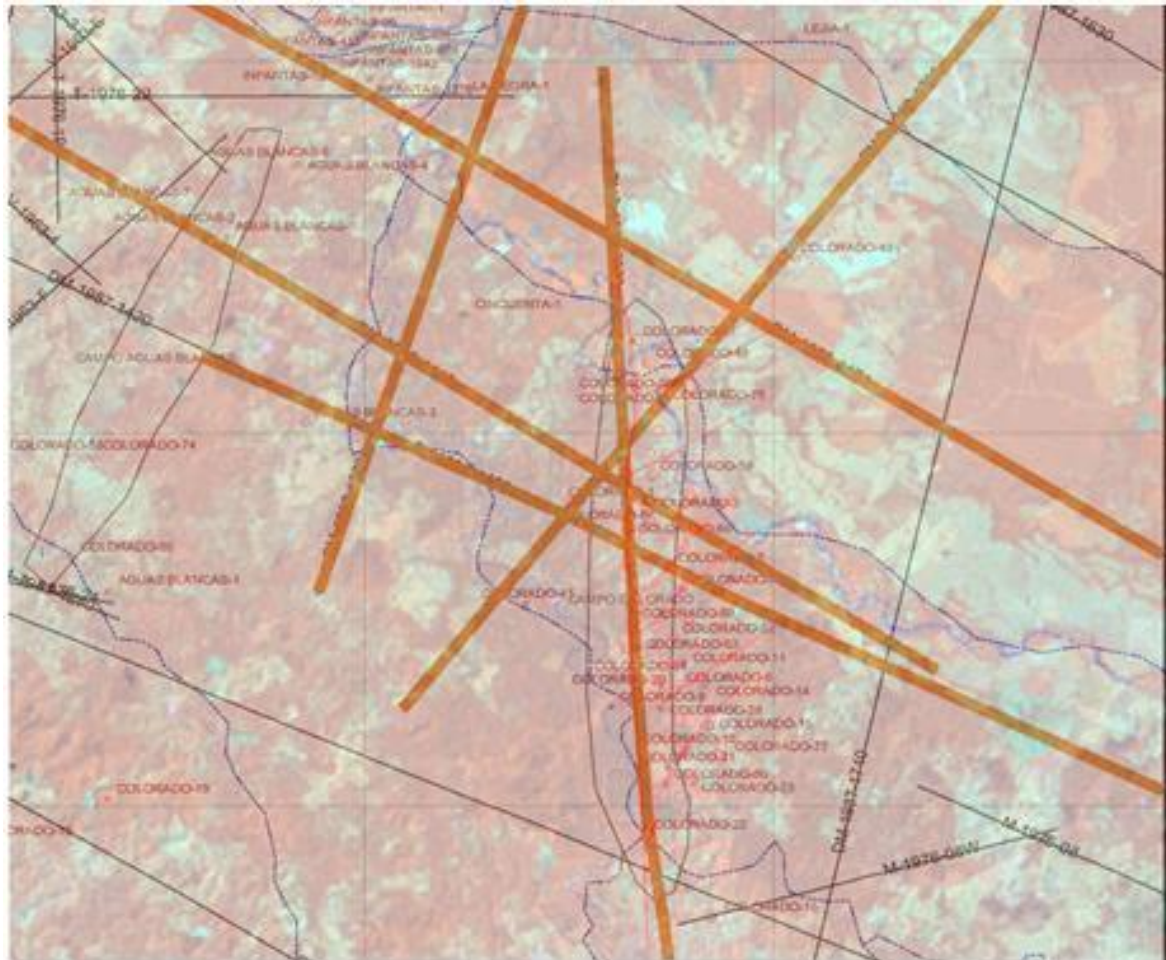
Figura 37. Mapa base (Proyecto Spring), con líneas sísmicas superpuestas al anterior modelo estructural con el fin de tener una mejor idea de los rasgos estructurales que posiblemente serán identificados en cada línea.
