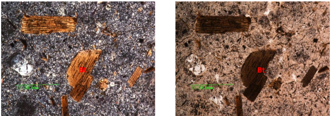
Figura 19. Aspecto microscópico de biotitas, en una matriz Vítreo con textura perlítica de la muestra TPD-84-1.
