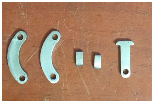
Figura 45. Piezas en lámina de espesor 3mm
