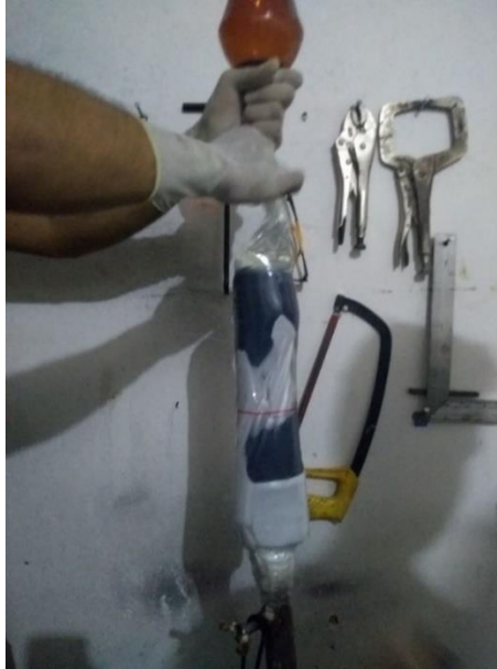
Figura 39. Aplicación de la resina al modelo
