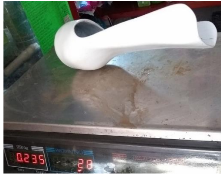
Figura 55. Peso de la interfaz en fibra de carbono
