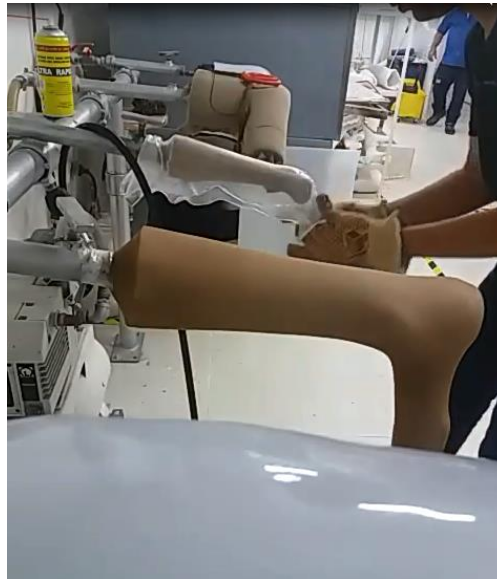
Figura 34. Modelo cubierto en lámina de polietileno
