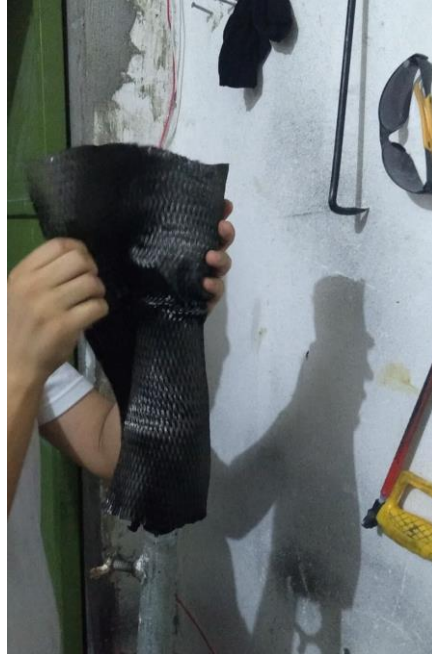
Figura 38. Modelo envuelto en fibra de carbono
