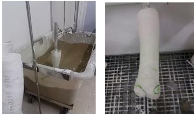
Figura 32. Negativo del molde en yeso para moldear
