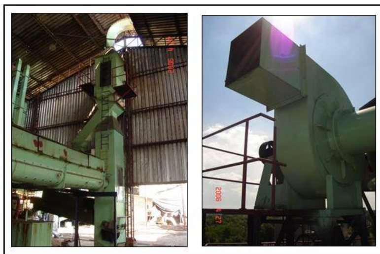
Figura 5. Sistema de separación neumática: columna y ventilador.
