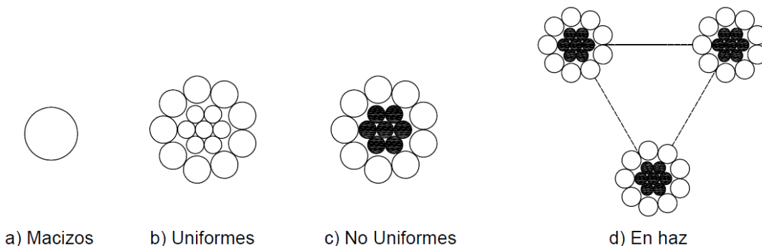
Figura 2.7: Conductores empleados en las líneas aéreas de alta tensión.
